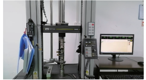
图 3 INSTRON-5866 型拉伸试验机
