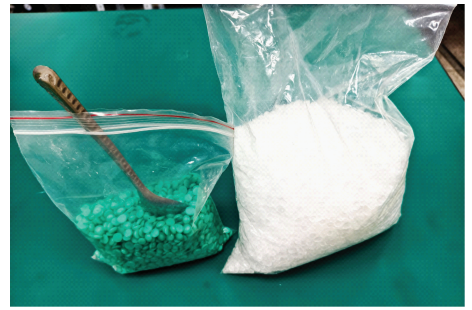
图 15 蜡芯制作采用的两种铸造蜡蜡珠
