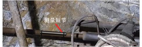
图 6 实钻实验
