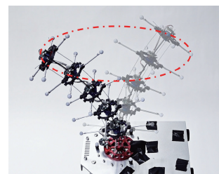
图 6 机械臂运动轨迹示意
