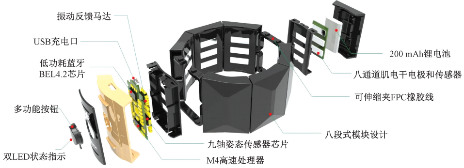
图2 gForcePro+臂环硬件组成
