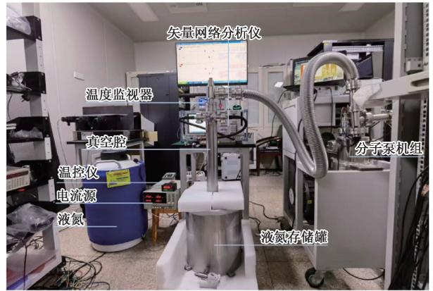
(a) 超低温谐振腔测试系统实物
