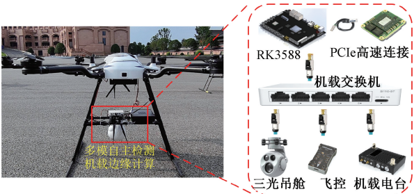
图 17 本文搭建的无人机多模检测系统
