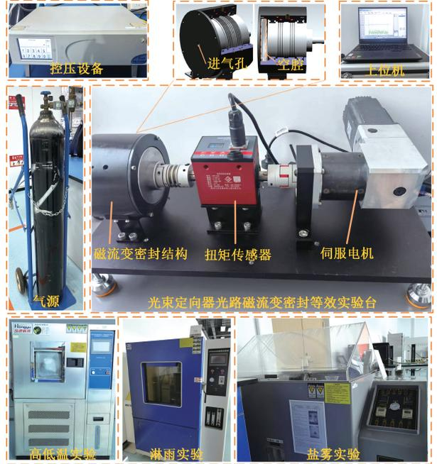
图 12 磁流变密封等效实验台
