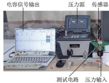
图11 传感器压力测试平台
