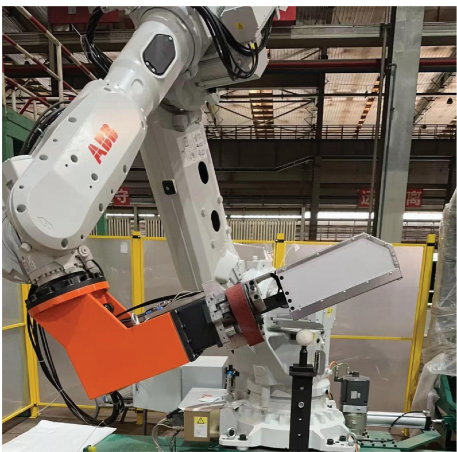
图 10 机器人扫描标准球进行手眼标定试验 Fig. 10 Robot scans the standard ball for hand-eye calibration test
