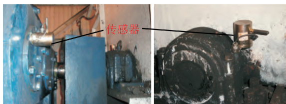
(d) 减速器与轴承座故障监测 (d) Fault monitoring of reducer and bearing seat
