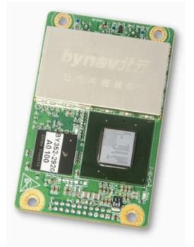
图11 RTK 定位板卡
