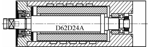
图 3 电主轴系统结构简图
