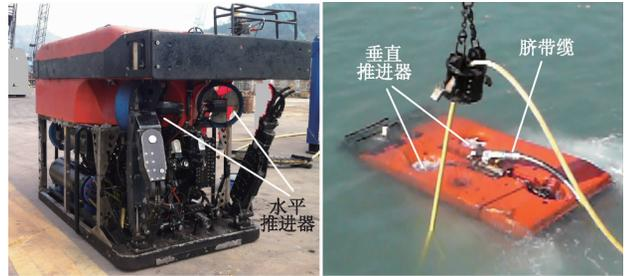
图 9 本教研室研制的作业型 ROV
