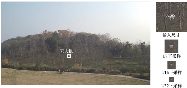
图 14 YOLOv8 中无人机目标下采样尺寸示例
