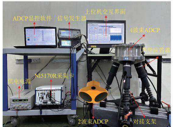
图 9 ADCP 陆上多波束校准装置实物
