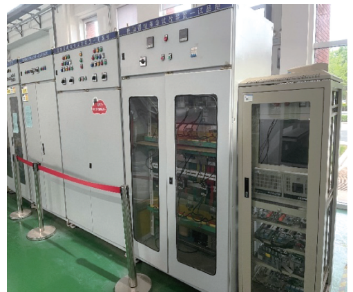
图3 交流接触器电寿命试验装置
