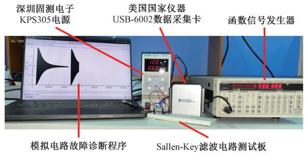
图7 用于测试电路故障的实验装置
