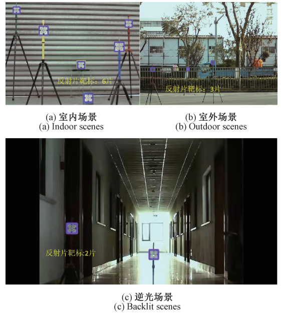
图 6 不同场景下反射片靶标识别与检测结果
