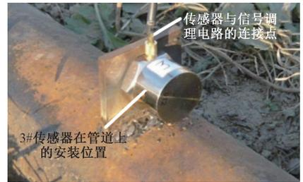
图5 实验现场某压电传感器放置图
