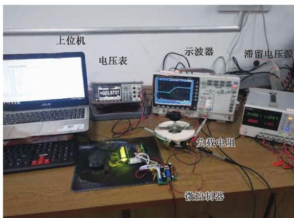
图 4 DC-DC 变换器实验测试平台
