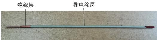
图 11 涂导电材料的漆包线
