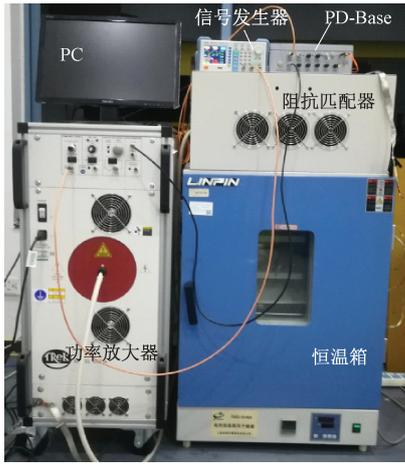
图 10 局部放电测试平台
