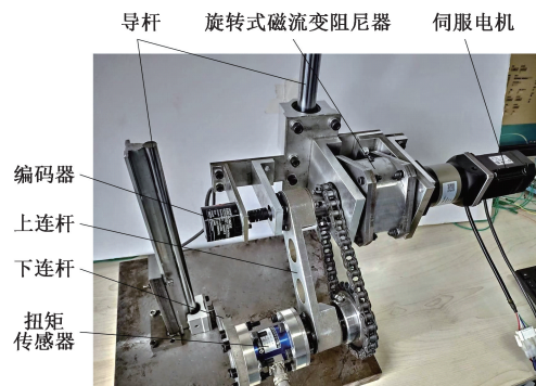
图 10 变刚度驱动器试验系统
