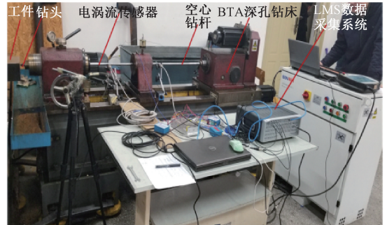
图 2 BTA 深孔钻削实验装置
