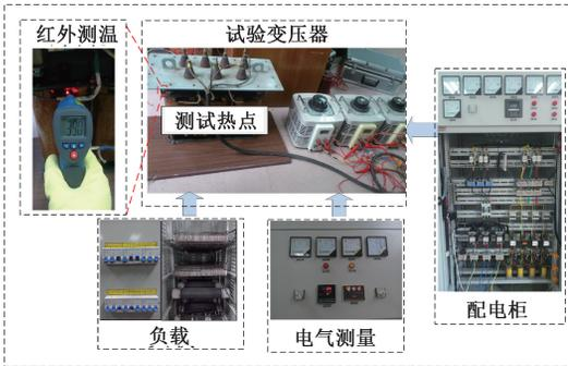
图13 红外测温试验布置
