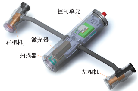
图5 激光扫描双目立体成像系统结构
