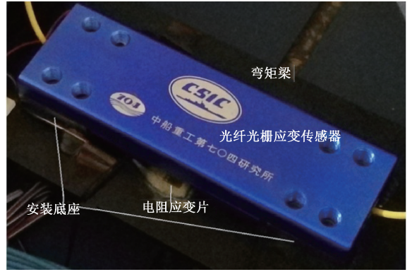
图 11 安装在弯矩梁上的船用光纤光栅应变传感器 Fig. 11 Fiber Bragg grating strain sensor for ship mounted on bending moment beam
