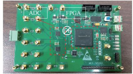
图7 自制FPGA电路板
