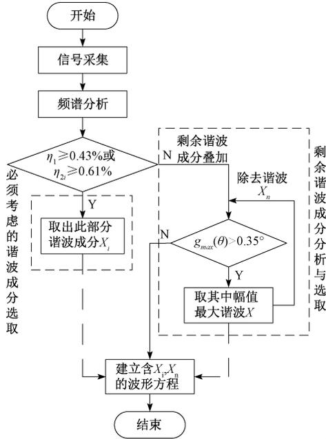
图 4 光栅莫尔信号波形建模流程
