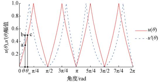
图 3 含谐波分量的正切曲线
