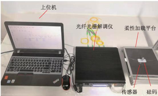
图 6 分布式光纤光栅传感系统
