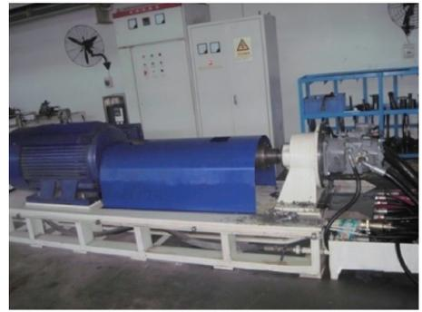
图 6 液压泵试验台
