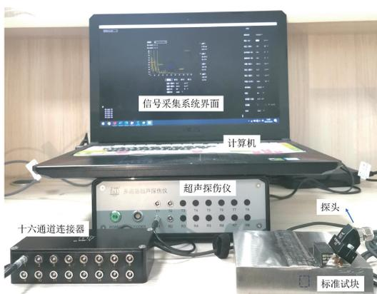
图 7 检测标准试块的实验测试系统平台
