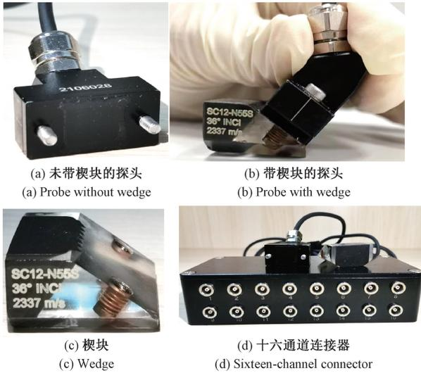
图 3 压电超声换能器线阵实物
