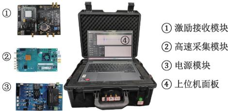
图 1 螺栓轴力检测系统
