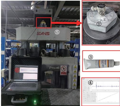
①待测螺栓②压电传感器③SWC-2耦合剂④上位机
