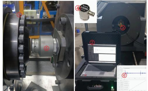
①螺纹摩擦系数试验机②螺栓轴力检测系统③待测螺栓
