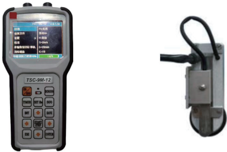
图 4 应力集中磁检测仪及扫描装置
