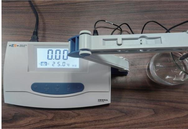
图 17 雷磁 DDSSJ-307A 电导率仪
