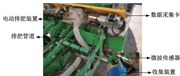
图 2 颗粒肥料质量流量检测系统
