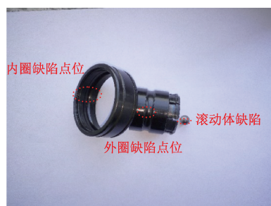
图 14 内圈、外圈、滚珠缺陷位置
