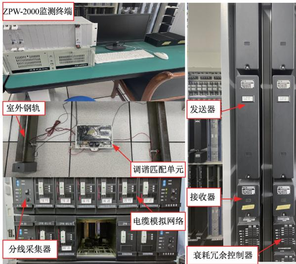
图 3 ZPW-2000A 轨道电路实验平台
