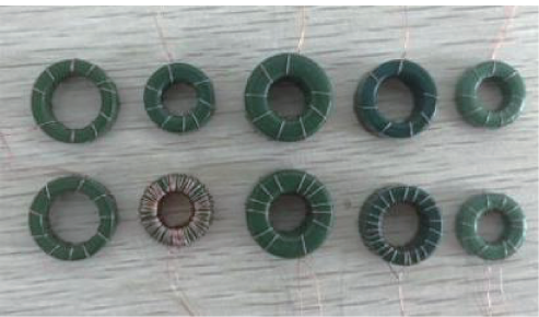
图 6 不同材质的绕线组合 Fig. 6 Winding combinations of different materials
