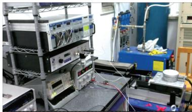
图 5 六维加速度传感器标定系统
