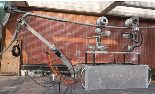
图 19 输电线路螺栓紧固机器人实验系统 Fig. 19 Experimental prototype of the bolt tightening robot
