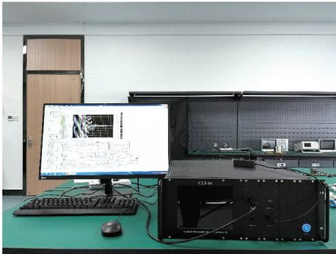
图 11 多通道超声导波收发系统
