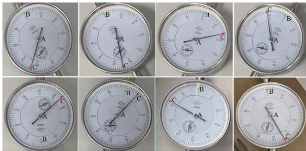
图9 倾斜指针仪表的关键点检测结果
