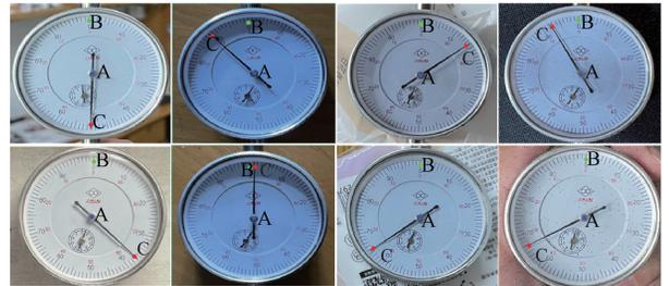
图 8 复杂指针仪表的关键点检测结果
