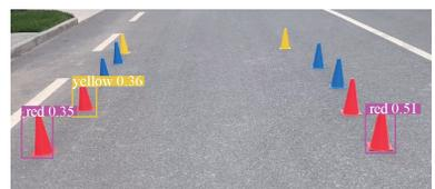
图 7 YOLOv3 远处小目标的识别效果
