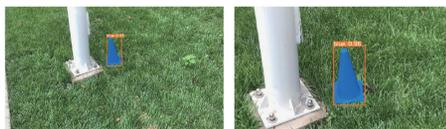
(c) 改进后 YOLOv5 的检测效果
