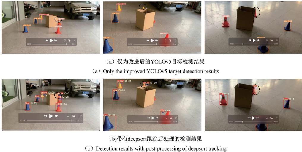
图 13 目标检测与加入跟踪处理的检测模块的检测结果对比
