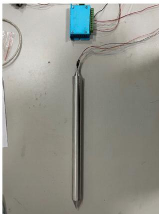
图 9 冲击挤密式潜入器样机
