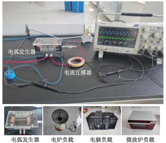
图 2 串联故障电弧发生平台
