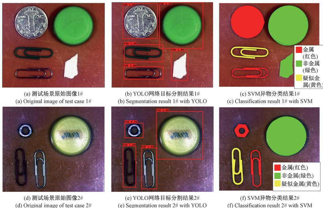
图 12 金属异物检测实验结果
