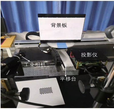
图 7 测量平台 Fig. 7 The measurement platform
