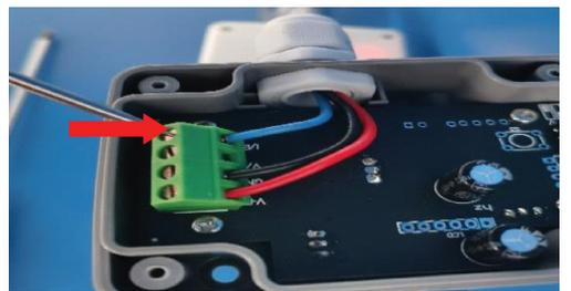
图 9 传感器模拟故障示意图
