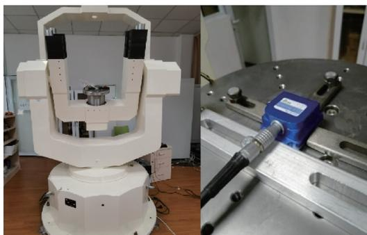
图 4 IMU 安装示意图
