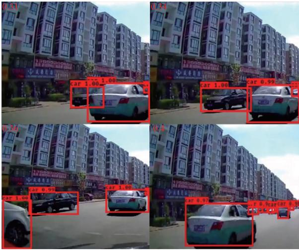
图1 车辆跟踪检测结果示意图
