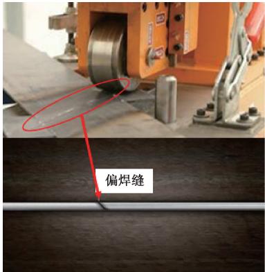
图 2 偏焊缝 Fig. 2 Bias weld
